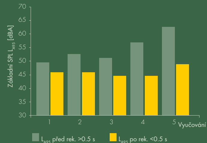
Zvýšení úrovně hluku při aktivitě (LA95) před a po rekonstrukci
