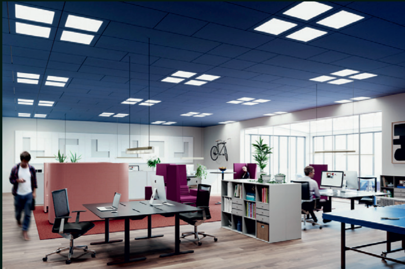
18 Eine vollflächig verlegte Akustikdecke ist die einfachste Lösung für eine große schallabsorbierende Fläche in einem Raum. Mit zusätzlichen Wandabsorbent als Ergänzung entsteht so eine wirklich optimale Raumakustik.
