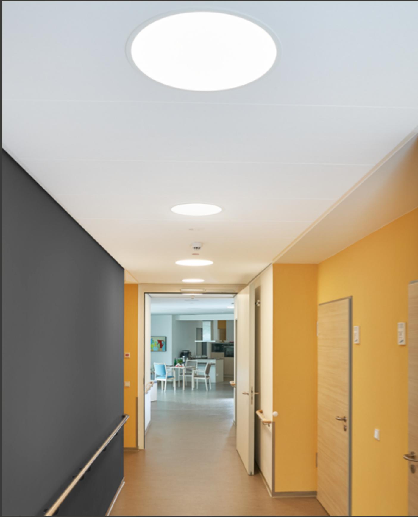
FOCUS D/A Für Flurlösungen. Extra-lange Akustikpaneele mit verdeckter Querschiene.
