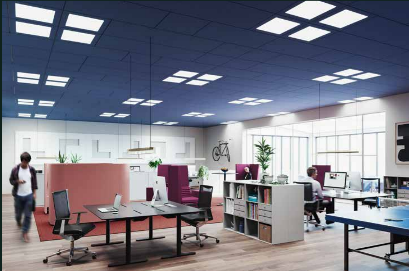
Een akoestisch plafond van muur tot muur is de gemakkelijkste manier om een groot geluidsabsorberend oppervlak in een ruimte te creëren, voeg andere absorbers toe zoals wandpanelen om een werkelijk optimale geluidsomgeving te krijgen.
