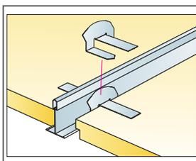
Connect Sicherungsclip E (patentiert)
