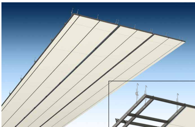
Cross-Lock systeem onder hellend dak
