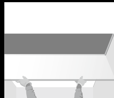
Při instalaci se kazeta zatlačí proti pružině v profilu, dokud nezapadne do drážky.
