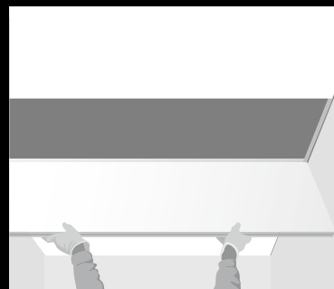
Når det installeres presse loftpladen imod fjederen i profilet, og klikkes ind i rillen.
